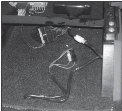
& immobilizer con il suo cablaggio ed il connettore bianco a 4 poli con il cablaggio formato da 2 cavi neri ad esso collegato.
